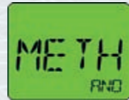
EXPLOSIMÈTRE 1 ÉCHELLE : CH 4
